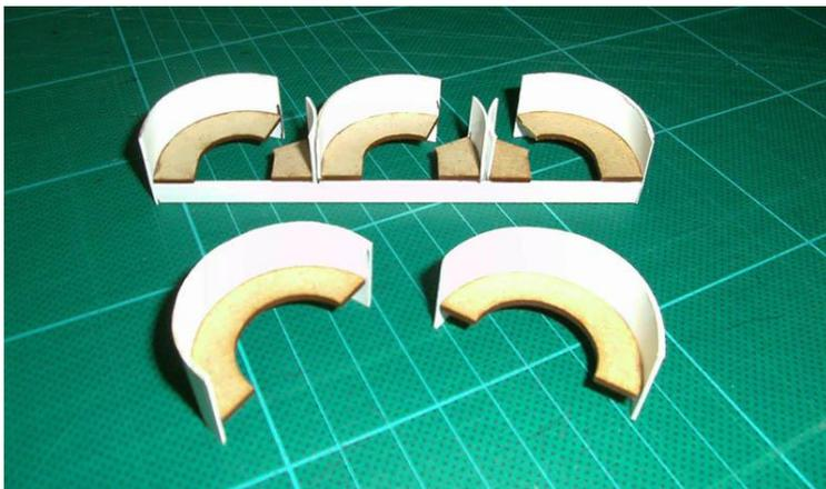
Die Abteilwände und die Bodenplatte sind aus 1.5 mm MDF geschnitten. Die Bodenplatte hat Schlitten um die Abteile und Wände zu richten und fest zu kleben.
